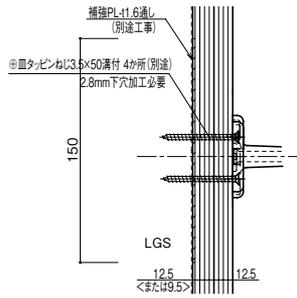
LGS + Pb<sub>t</sub>12.5 + Pb<sub>t</sub>12.5 又は Pb<sub>t</sub>9.5
