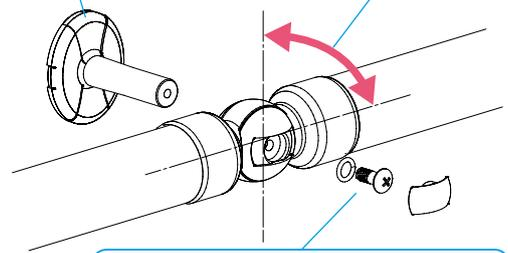
ブラケット組立用固定ねじ(Φトラス小ねじ M5×15)で座と本体の着脱が可能です。
